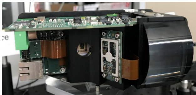
Abb. 1: 1D MEMS Spiegel LiDAR Prototyp
